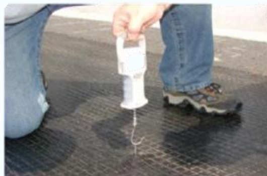
Foto 3. esquema de realización del ensayo de adherencia.
